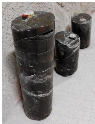
Abb. 2: Diese Bohrkerns enthalten Messzylinder, die radioaktive Stoffe wie sie in den Endlagerungs-Abfällen vorkommen enthalten. Das Experiment gibt Aufschluss darüber, wie ‚dicht‘ der Opalinuston für verschiedene Materialien ist bzw. wie lange diese brauchen, um den Ton zu durchdringen.
